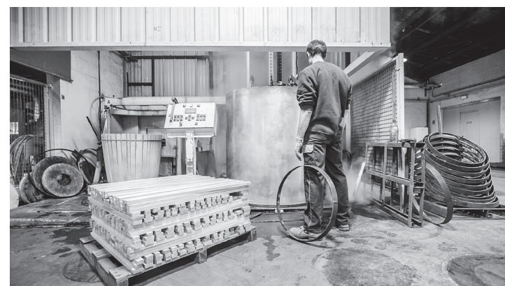
La fabrication de la barrique débute par l'assemblage et le cintrage des douelles (au premier plan). La fibre du bois est détendue grâce à la vapeur d'eau injectée dans la cloche (au centre de la photo).
