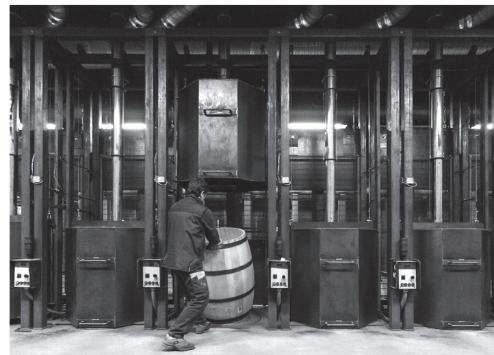
La chauffe : grâce au foyer à double cône, la chaleur est uniformément répartie autour de la barrique, dont les douelles ont été au préalable scarifiées pour éviter les cloques.
